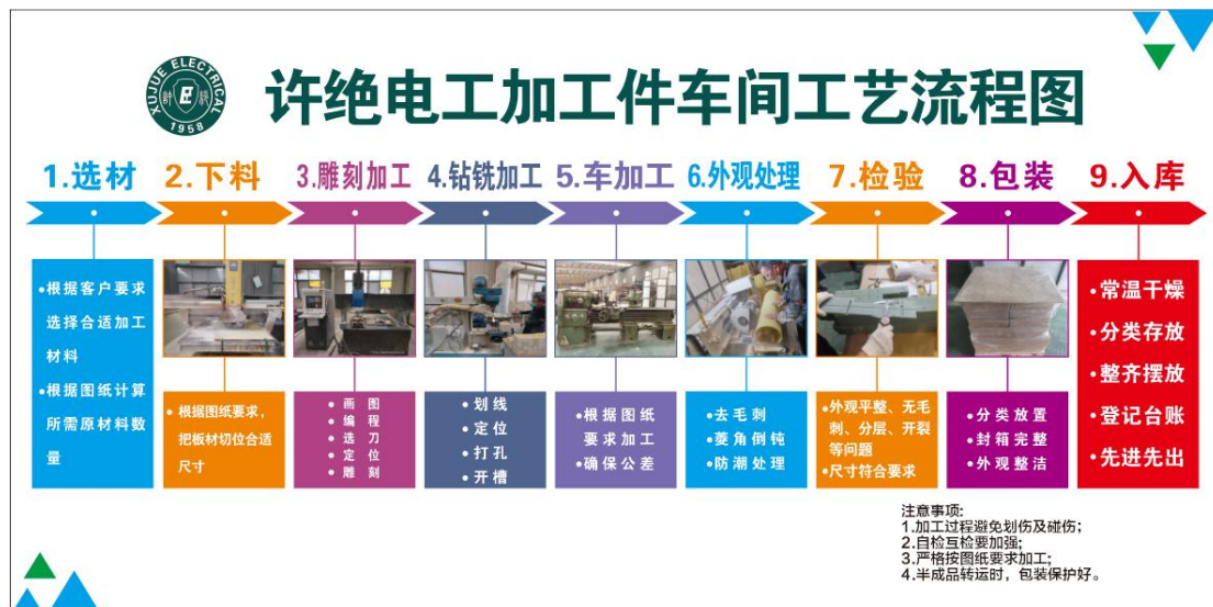
图 3.5 加工件车间工艺流程图
