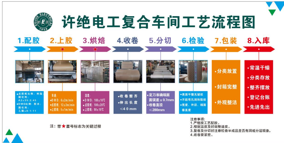
图 3.4 复合车间工艺流程图
