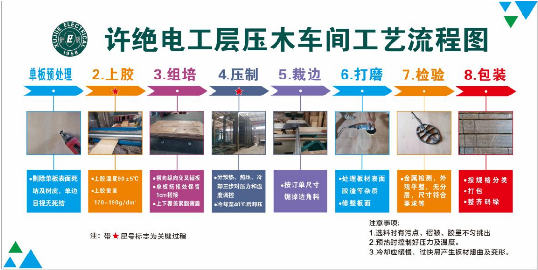
图 3.2 压木车间工艺流程图
