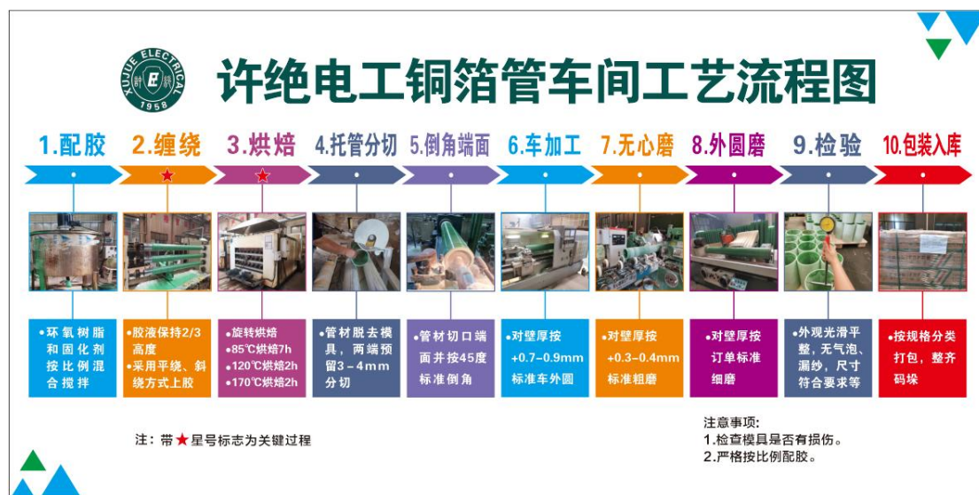
图 3.7 电工铜箔管车间工艺流程图
