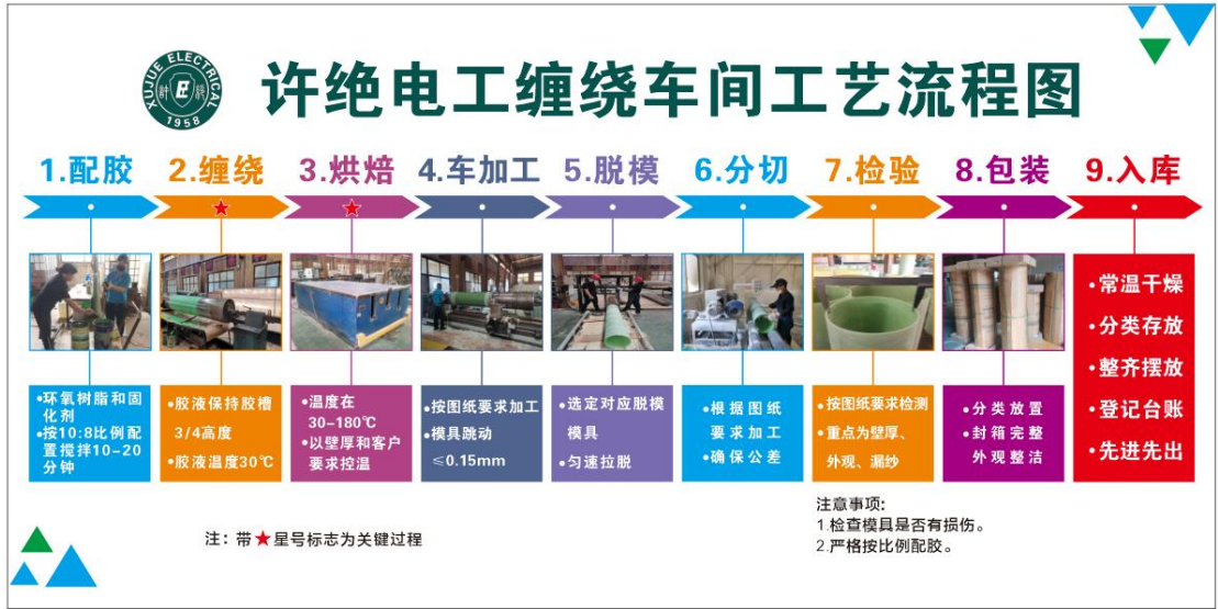
图 3.3 缠绕车间工艺流程图
