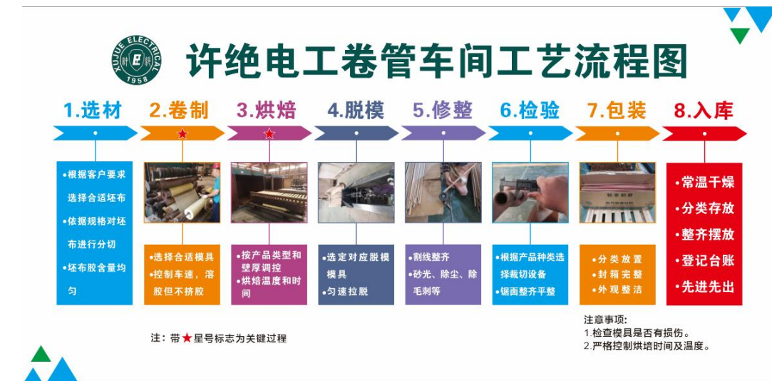
图 3.6 电工卷管车间工艺流程图
